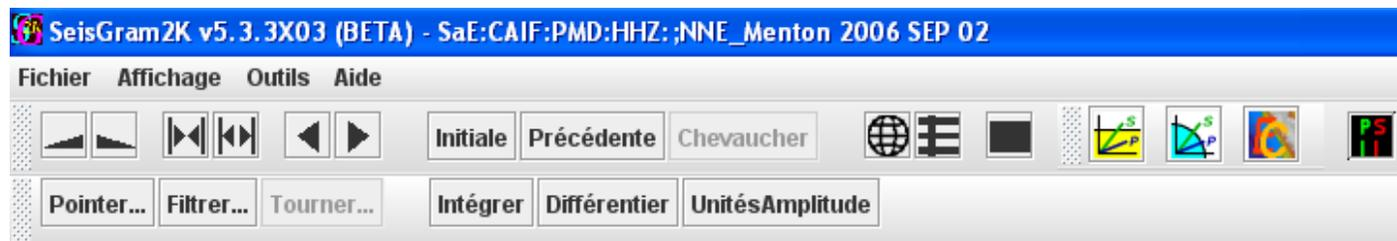
« Intégrer » permet d'obtenir l'amplitude du déplacement à partir de la vitesse de déplacement. « Différentier » fait l'inverse.
